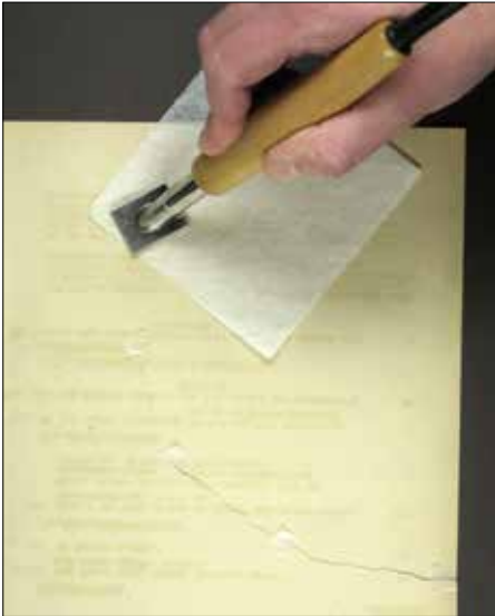
Archibondstücke werden mit einem Heizspatel aufgebügelt. Als Trennmaterial dient ein Parafilvlies (Foto: LKA Karlsruhe).
